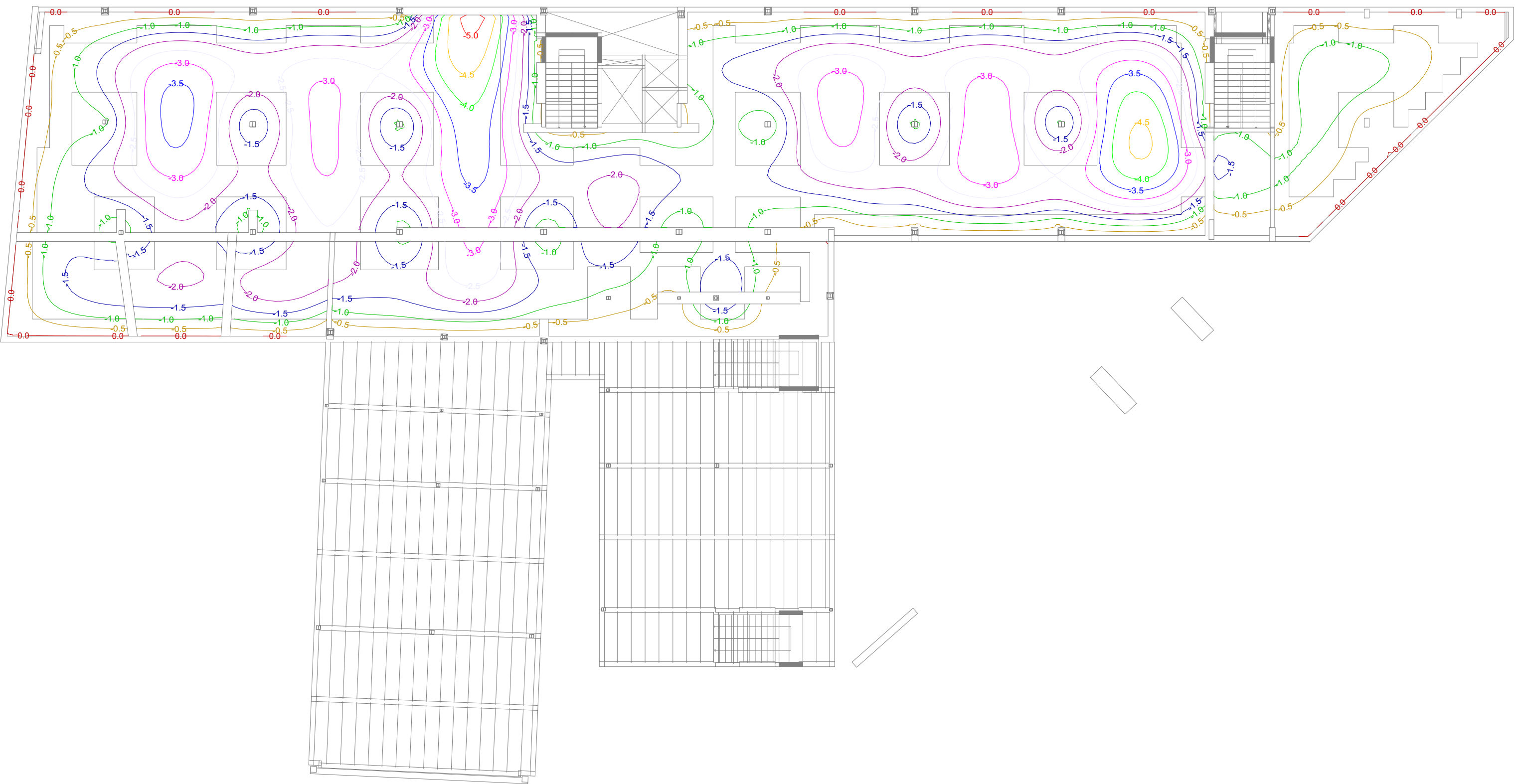
Forjado Suelo PBaja, Desplazamiento Z (mm), PP+CM+Qa(C)+Qa(E)+Nieve
